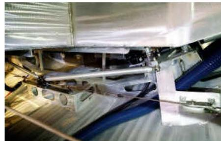
Ein durchgehender Kabelzug führt von den Rädern auf einen Traveller. Die Ruderquadranten werden von dort mit Schubstangen angesteuert
