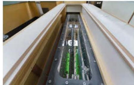
Das Schwert mit NACA-Profil ist vollständig in den Rumpf einziehbar. Die Plexiglas-Abdeckung auf dem Schwertkasten gewährt Kontrolle der Position
