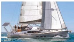
Robuster Blauwasserkreuzer mit Integral-Schwenkkiel. Der Rumpf ist im Rundspant aus Alu gebaut, das Deck aus GFK
