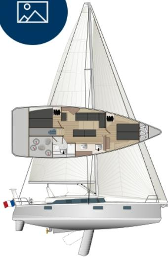
Typisch Ovni: mächtiger Rumpf, Integral-Schwenkkiel und zwei Stummelruder. Der Ausbau mit zwei Kabinen ist der Standard
